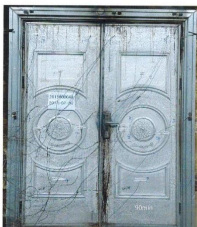
照片 2 耐火试验结束时试件情况
