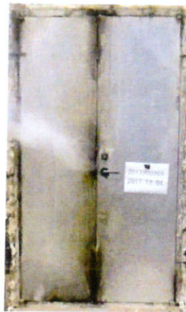
照片 2 耐火试验结束时试件情况
