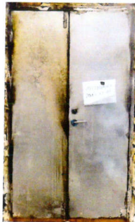
照片 2 耐火试验结束时试件情况
