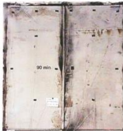
照片 2 耐火试验结束时试件情况
