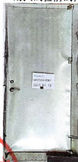
照片 2 耐火试验结束时试件情况
