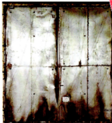
照片 2 耐火试验结束时试件情况
