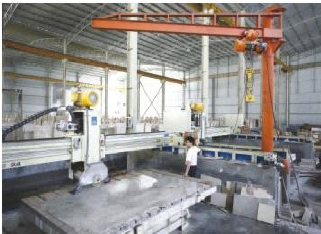
图 8：规格板切割（红外线桥切机）
