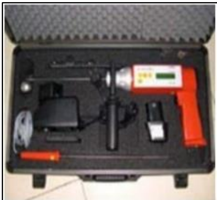
新拌混凝土测试仪 FCT-101
