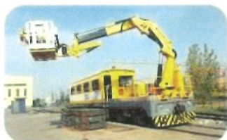
JW-4G型接触网腕臂作业车
