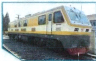
3CD-1000型重型轨道车 (两套动力, 设电阻制动)
