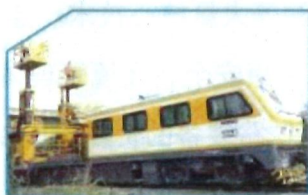
GCY-300 II s型重型轨道车 (隧道检修)
