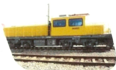
GCD-300型双动力牵引车（调车机外形）
