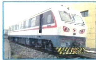
GC-300x型重型轨道车 (具有自动换挡和液力制动功能)
