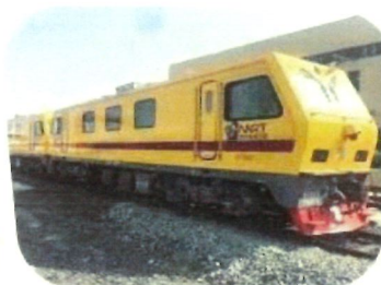
GCD-300型双动力牵引车（轨道车外形）
