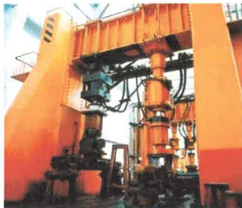
1500KN 电液伺服结构疲劳试验台
