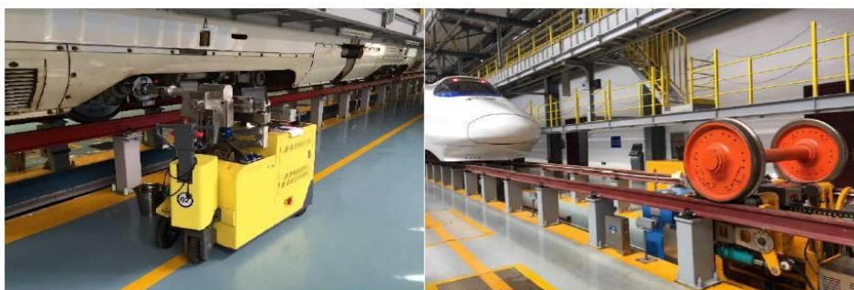
图：空心车轴超声波探伤机
