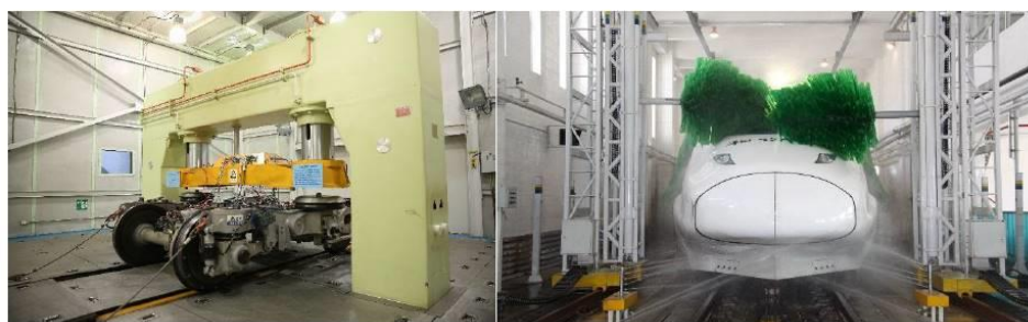
图：转向架试验台
