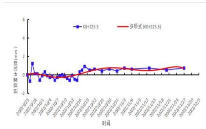
图7.21 K0+225.5拱顶累计沉降曲线图
