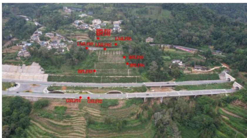
(b) 裂缝监测点
