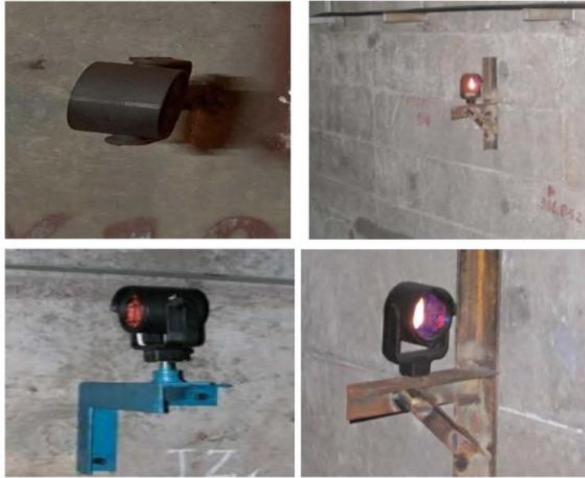
隧道侧墙基准点布设图
