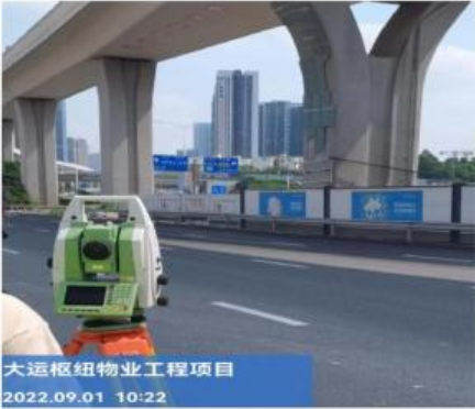
桥墩竖向位移、水平位移监测点图
