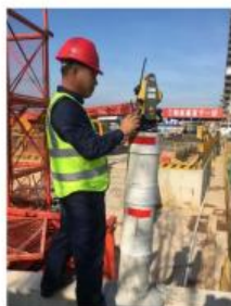
位移基准点示意图
