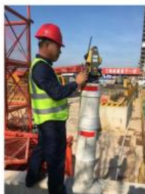
位移基准点示意图
