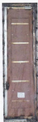
照片 2 耐火试验结束时试件情况
