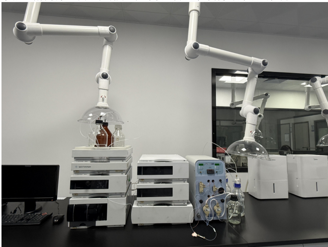
液相色谱分析仪：用于呋喃丹、灭草松、莠去津等有机物项目的检测
