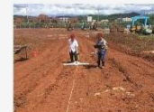
株洲农副产品批发交易市场中心场地岩溶地质雷达探测
