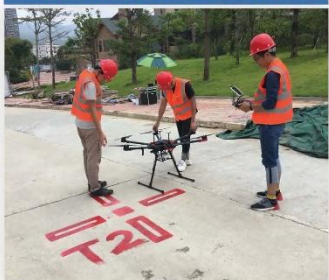
无人机倾斜摄影快速获取灾区区域影像
