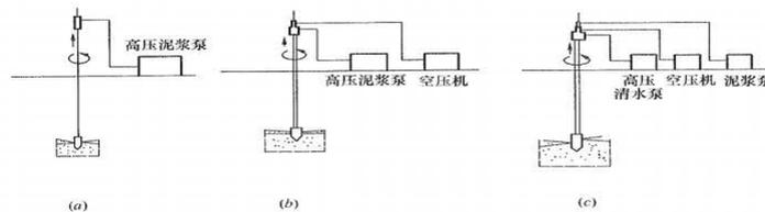
图 10-2 喷射注浆法施工工艺流程
