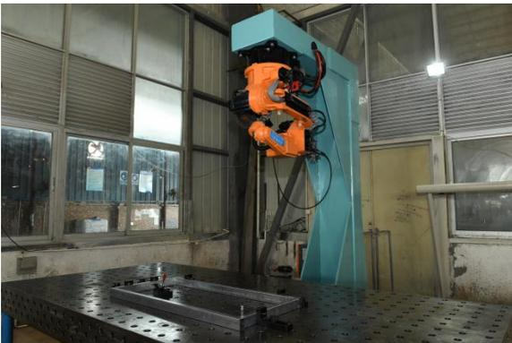
图片 14-关键设备：门框自动生产线
