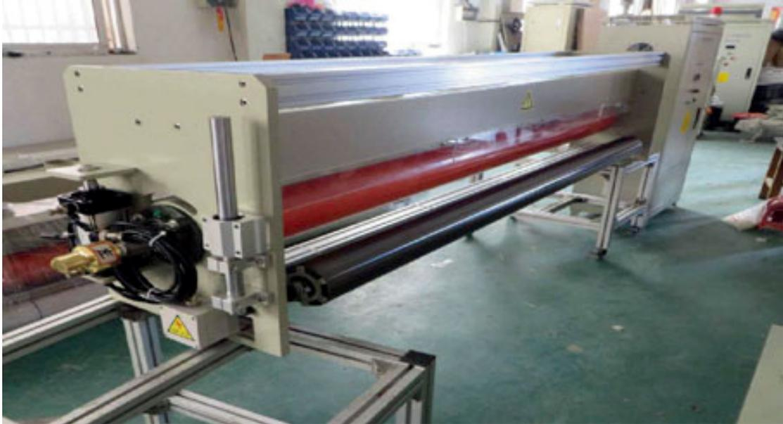
**晾板系统:** 复合板经过粘接、发泡以及切割过程, 成型后具有一定高的温度, 此时不宜用来码垛打包, 以免影响复合板的平整度。有了晾板系统, 可以缓慢降温, 从而达到成品板材完全固化稳定。
