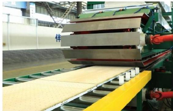
自动喷胶/淋胶机：实现自动化连续作业，精准控制胶水输出量，提高了产品的外观质量和粘接的可靠性、耐久性。
