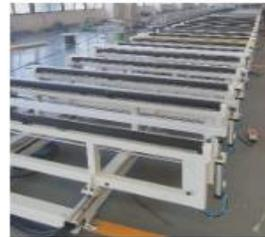
◆门窗数控铰链孔钻孔机 LZJ2A-CNC-2200
