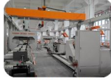
幕墙立柱自动加工线 Automatic processing line
