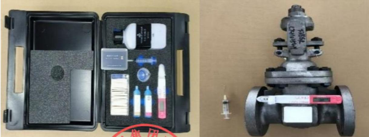
针对漆膜厚度检测，公司配备有高精度涂层测厚仪，仪器是抗干扰分体探头能胜任各种材质表面，可快速精准测量。方便检测各部位的漆膜厚度，保证了油漆的耐腐蚀性。
