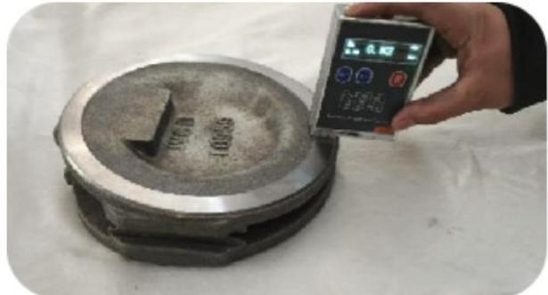
密封面硬度包括特殊配件的材质硬度，都是影响阀门寿命的重要参数，为保证硬度达标，公司配备多种先进的硬度计，精度高、测试灵活、读数方便，可现场检测，通过实时检查确保每批产品硬度达标。
