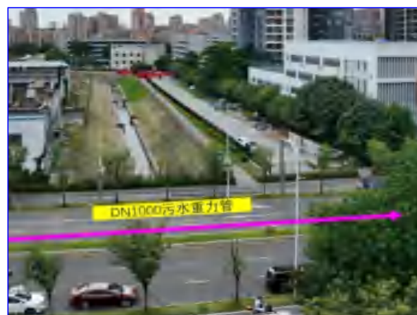
项目振兴路污水干管工程上石家路-公明南环大道段下穿公明排洪渠河道
