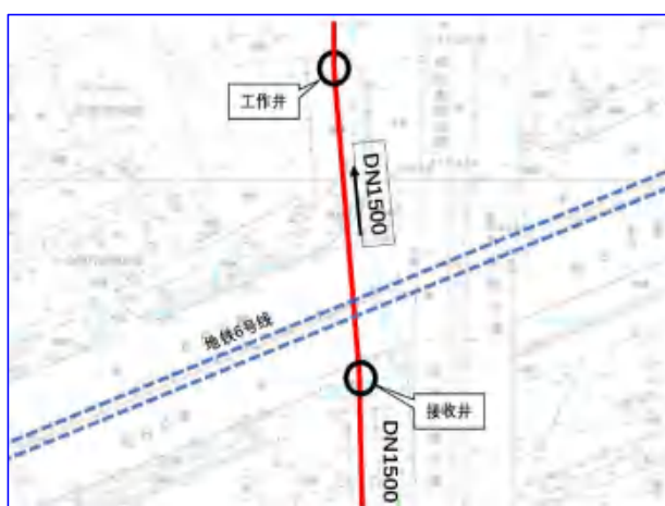
公明西环大道段 DN1500 污水管顶管施工段下穿地铁 6 号线
