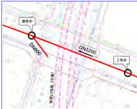
振兴路污水主干管工程连续两次下穿地铁 13 号线（在建）
