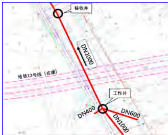
振兴路污水主干工程连续两次下穿地铁13号线（在建）
