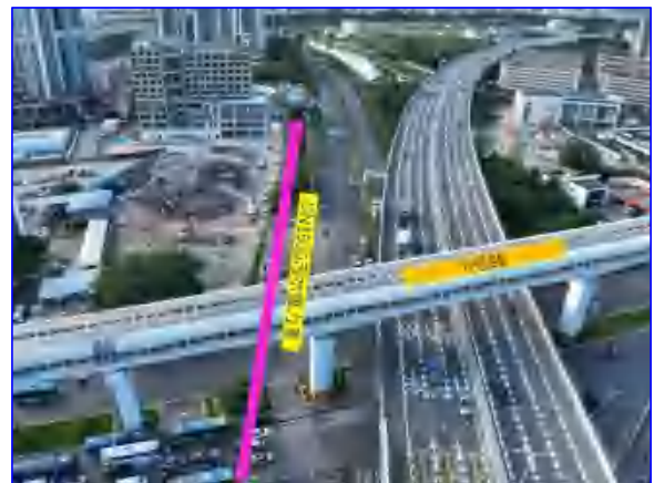
公明西环大道段 DN1500 污水管顶管施工段下穿地铁 6 号线
