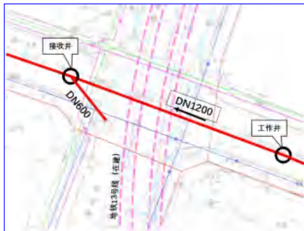
振兴路污水主干工程连续两次下穿地铁 13 号线（在建）
