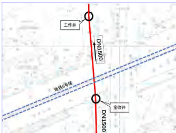
公明西环大道段 DN1500 污水管顶管施工段下穿地铁 6 号线
