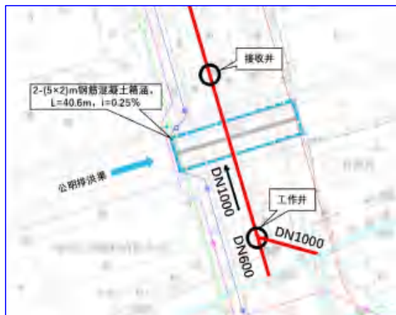
振兴路污水主干工程上石家路-公明南环大道段下穿公明排洪渠河道
