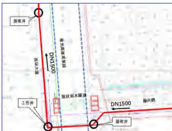
振兴路至西环大道 DN1500 污水管顶管施工段下穿南光高速高架桥段
