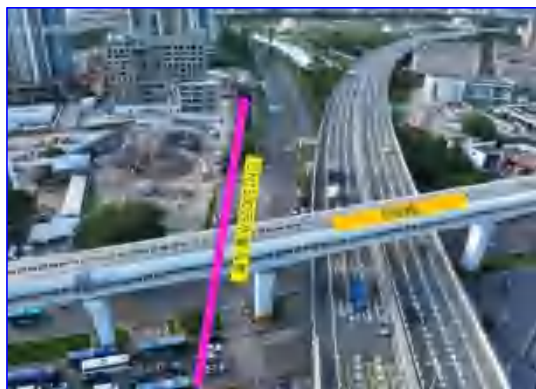
振兴路至西环大道 DN1500 污水管顶管施工段下穿南光高速高架桥段
