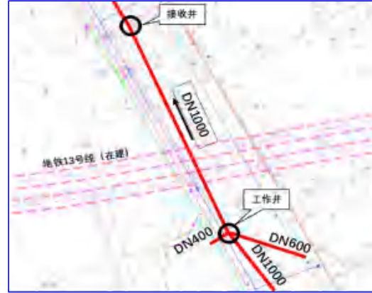
振兴路污水主干管工程连续两次下穿地铁 13 号线（在建）
