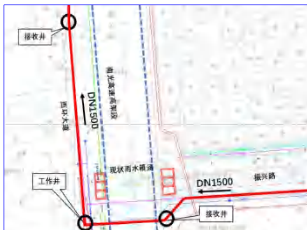
兴路至西环大道 DN1500 污水管顶管施工段下穿南光高速高架桥段
