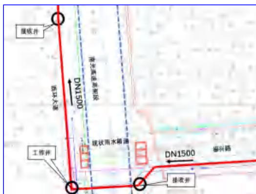
振兴路至西环大道 DN1500 污水管顶管施工段下穿南光高速高架桥段
