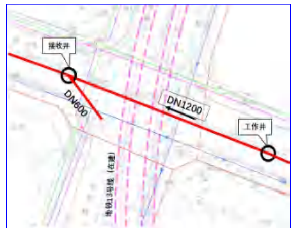
振兴路污水主干工程连续两次下穿地铁13号线（在建）
