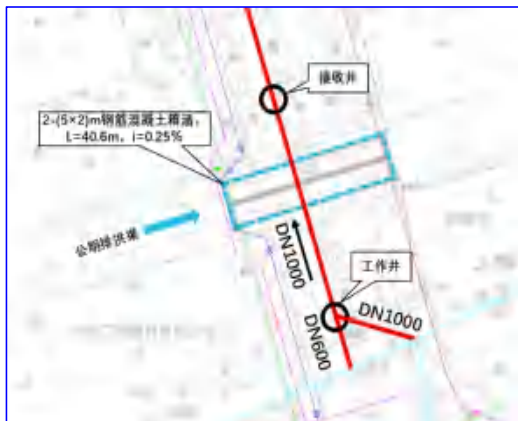
项目振兴路污水主干管工程上石家路-公明南环大道段下穿公明排洪渠河道
