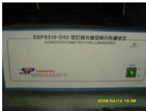
灯具光度空间分步测量仪
