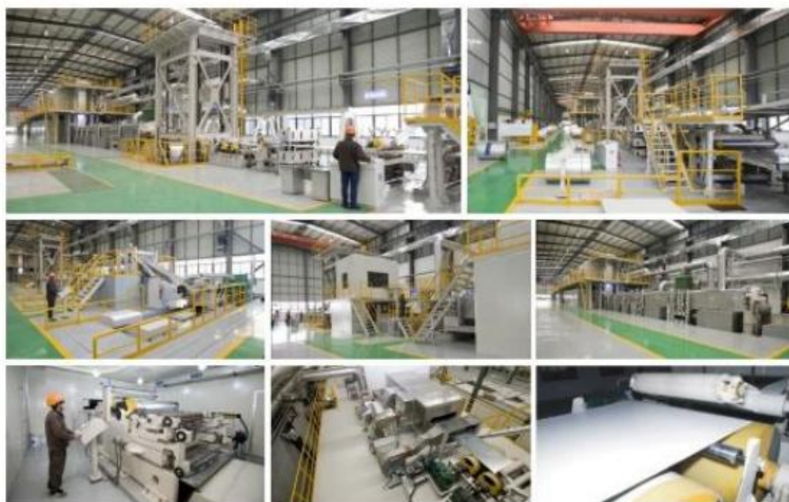
行业领先的三涂三烘预辊涂铝板/钢板生产线
