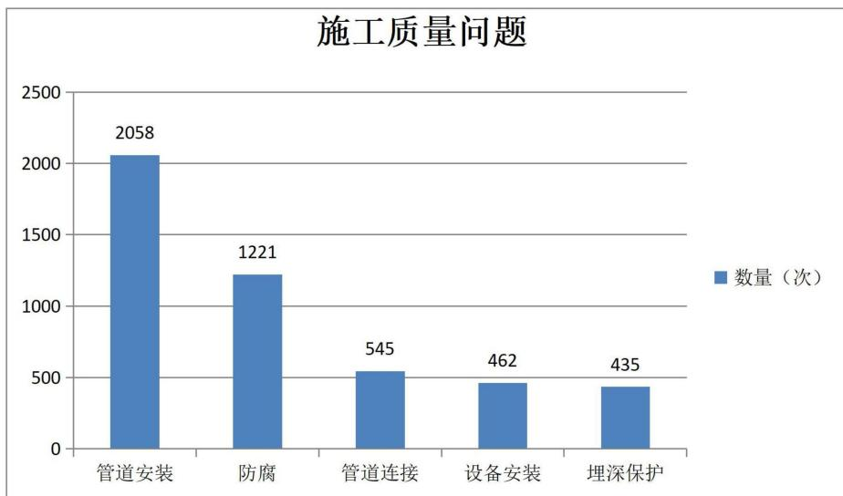
依据抽取数据分析，燃气工程现场较为突出的工程质量问题是管道安装、防腐、管道连接等方面。
