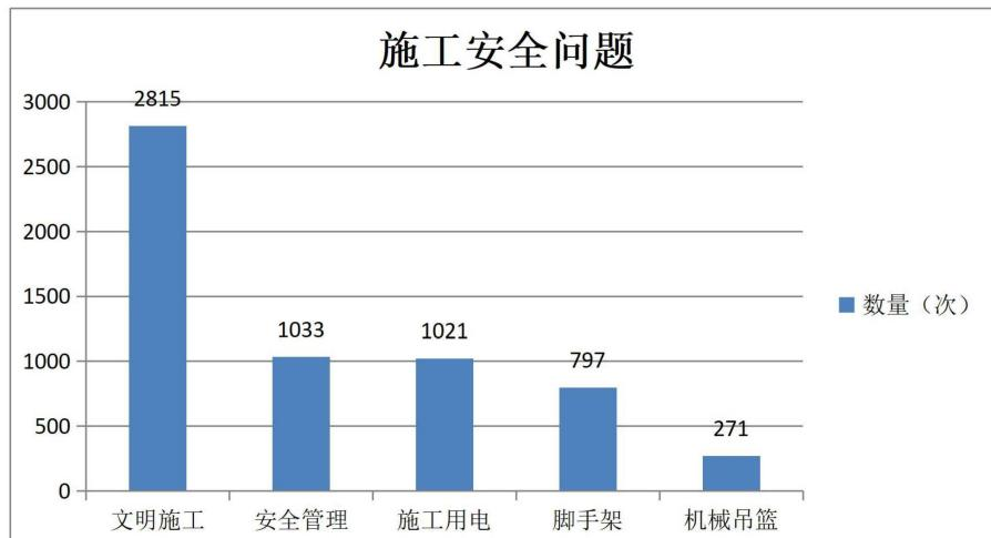
依据抽取数据分析，工程承包商在文明施工存在的问题突出，施工用电、脚手架及机械吊篮三大高危作业存在安全问题较多。
