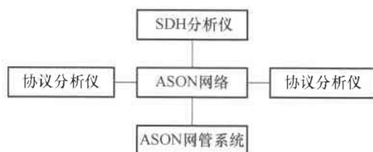
图 5.4.1 控制平面功能检查连接框图
