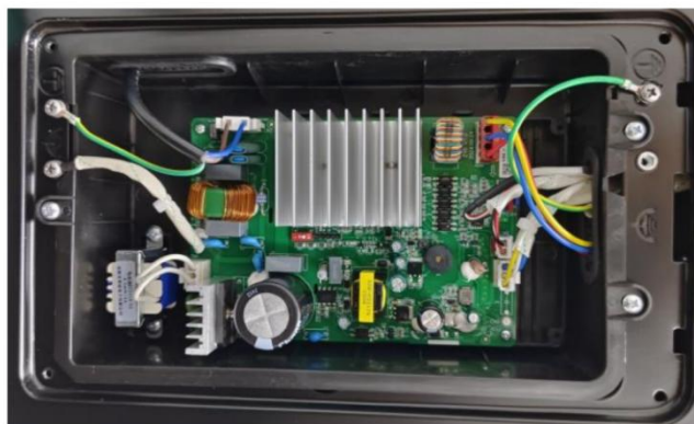
(CXW-258-02-JQC7T、CXW-258-02-JQC1T、CXW-258-02-JC01T) 内部结构
