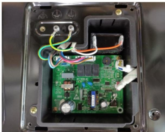
变更后的电源板结构
