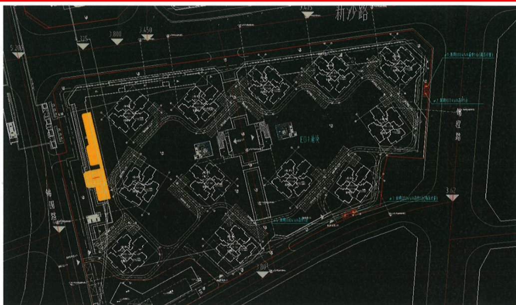
红线内4台800kva变压器安装位置
