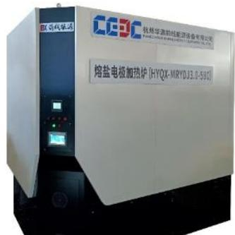
熔盐电极加热炉
