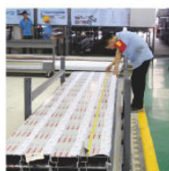
铝型材切割尺寸检验
