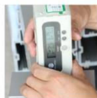
喷涂颜色检验 (色差仪)
