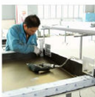
打螺丝钉时要蘸取适量 密封胶以防水
