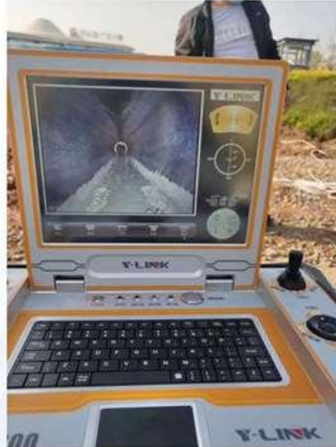
管道CCTV检测机器人控制盒与计算机 排水管道污染源排查
