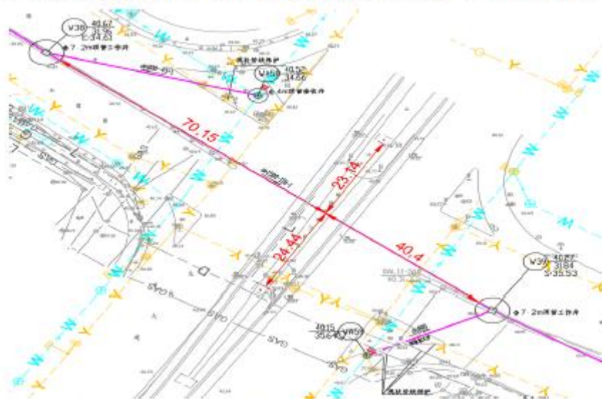
图 1.1-1 WA38~WA39 井段与已建地铁 3 号线桥墩位置平面图（下穿）
