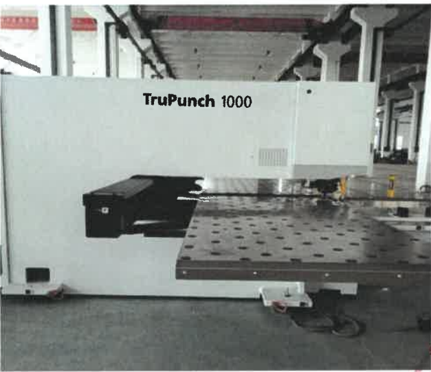
图 1：TruPunch 1000 通快数控多工位冲床 产地：德国 品牌：通快 用途：冲孔
