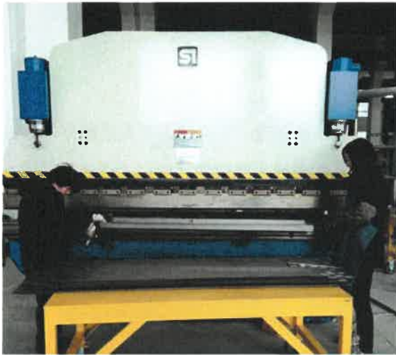
图 3：数控液压折弯机 产地：上海 品牌：新力 用途：折弯
