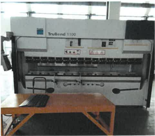
图 2：TruBend 1100 通快折弯机 产地：德国 品牌：通快 用途：折弯
