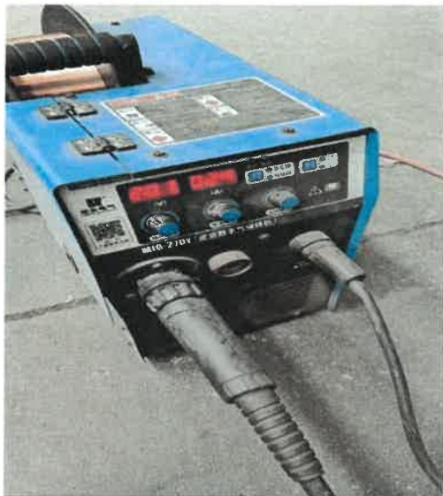
图 9：数字化双丝智能化焊接装置 用途：焊接
