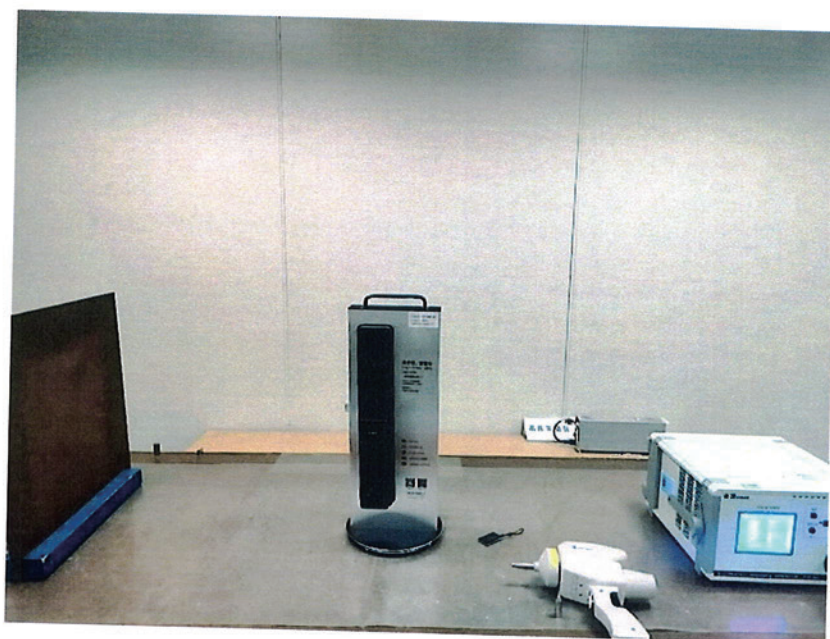
图三: 静电放电抗扰度和数字钥匙抗静电试验检测布置图
