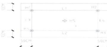
(室内空间尺寸示意图, 测点位置可根据实际情况调整)
