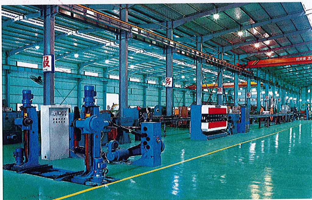
全自动化铝杆及铝合金杆连铸连轧生产线
