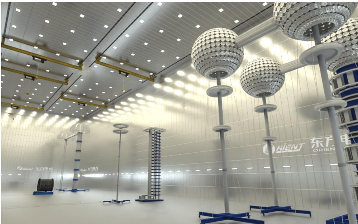
国内、世界一流试验大厅：交流 1600kV、直流±2600kV、冲击 4200kV
