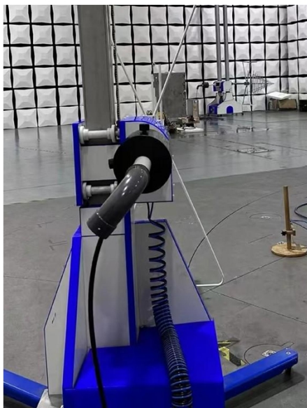
图 6 空间辐射发射检验布置-2
