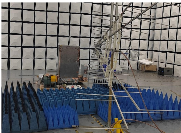
图 14 空间辐射抗扰度试验布置-2
