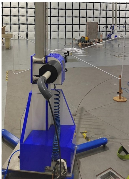
图 5 空间辐射发射检验布置-1
