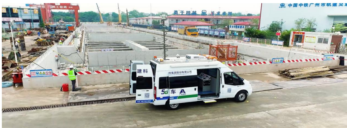
多功能工程应急抢险智能监测车（5G智能检测车）
