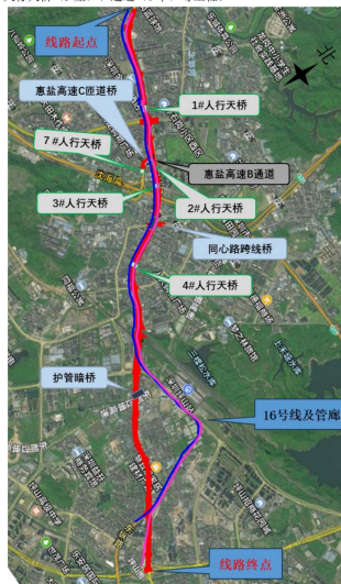
图 1.1-2 拟建线路工程示意图
