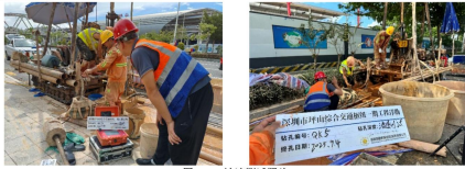
图 1.6-5 波速测试照片
