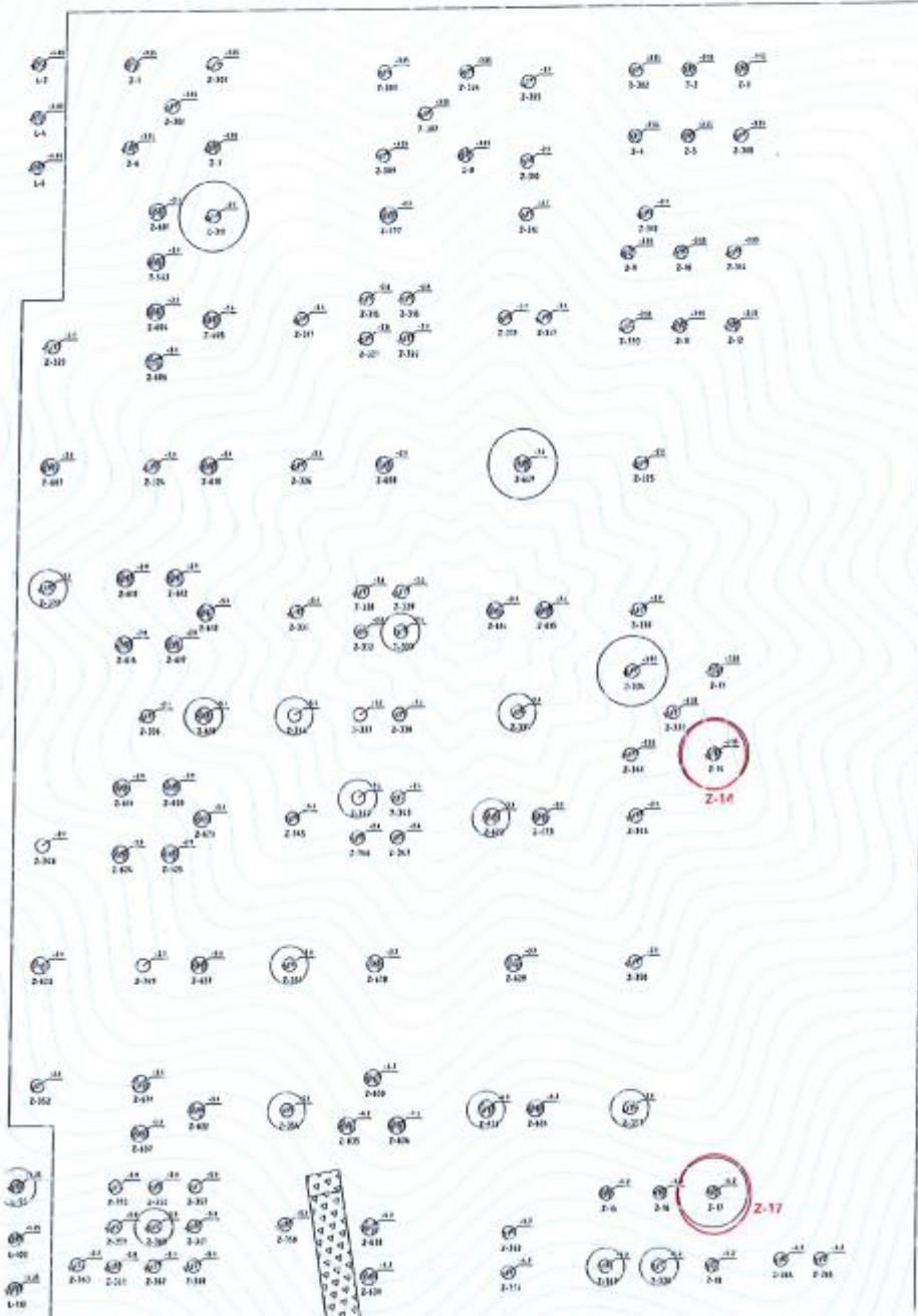
#1、#2 锅炉及除渣间桩位平面示意图
