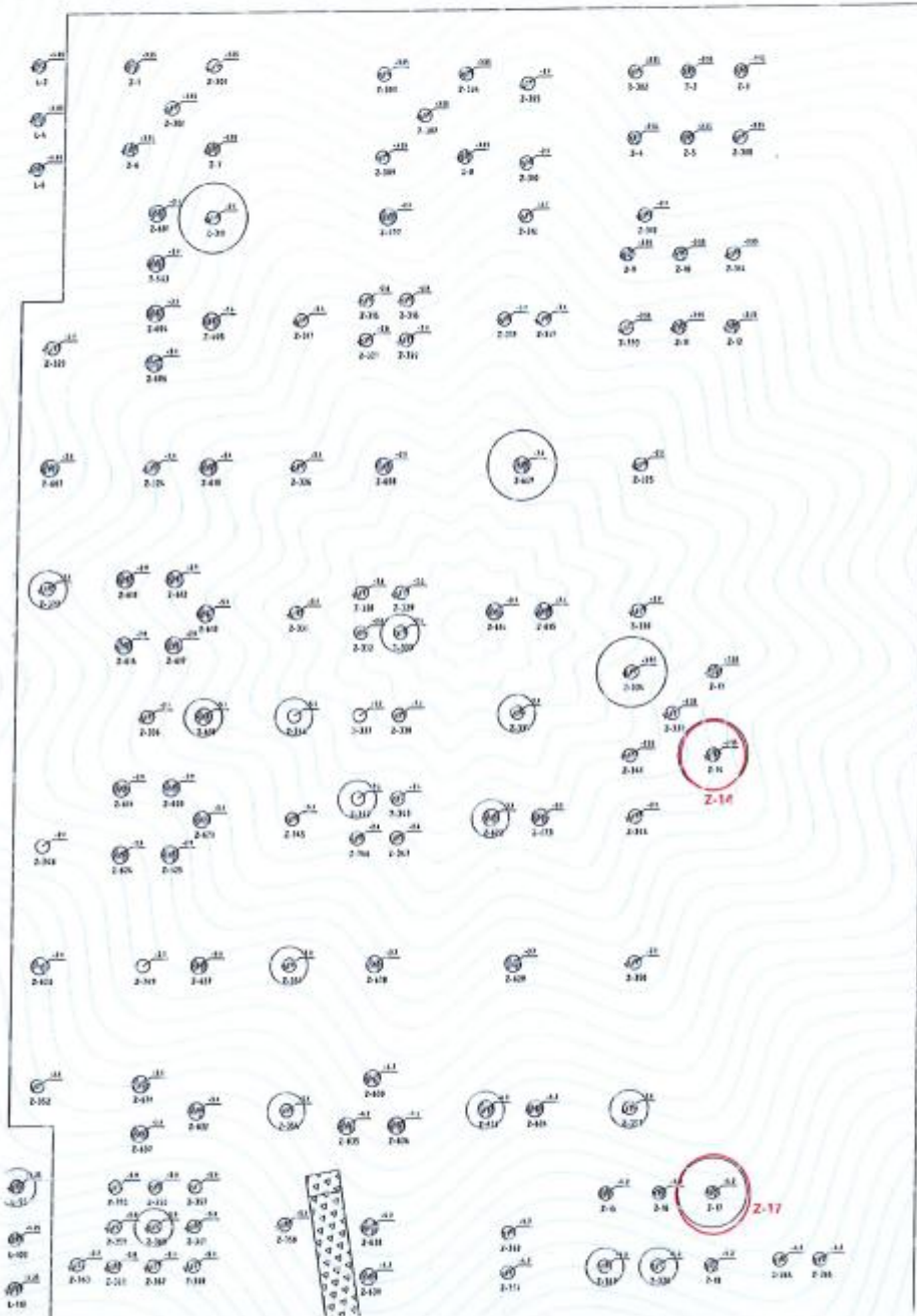
#1、#2 锅炉及除渣间桩位平面示意图
