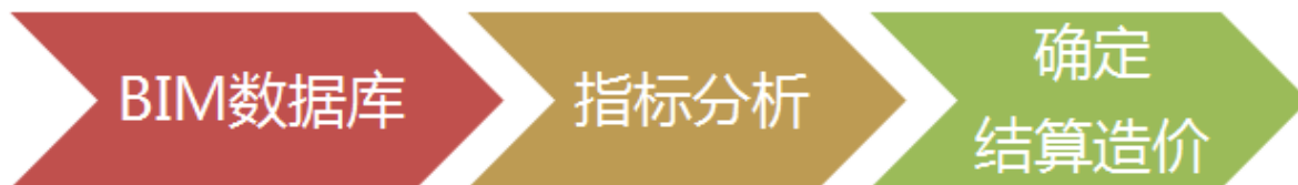
图：基于 BIM 数据进行结算造价分析、审核
