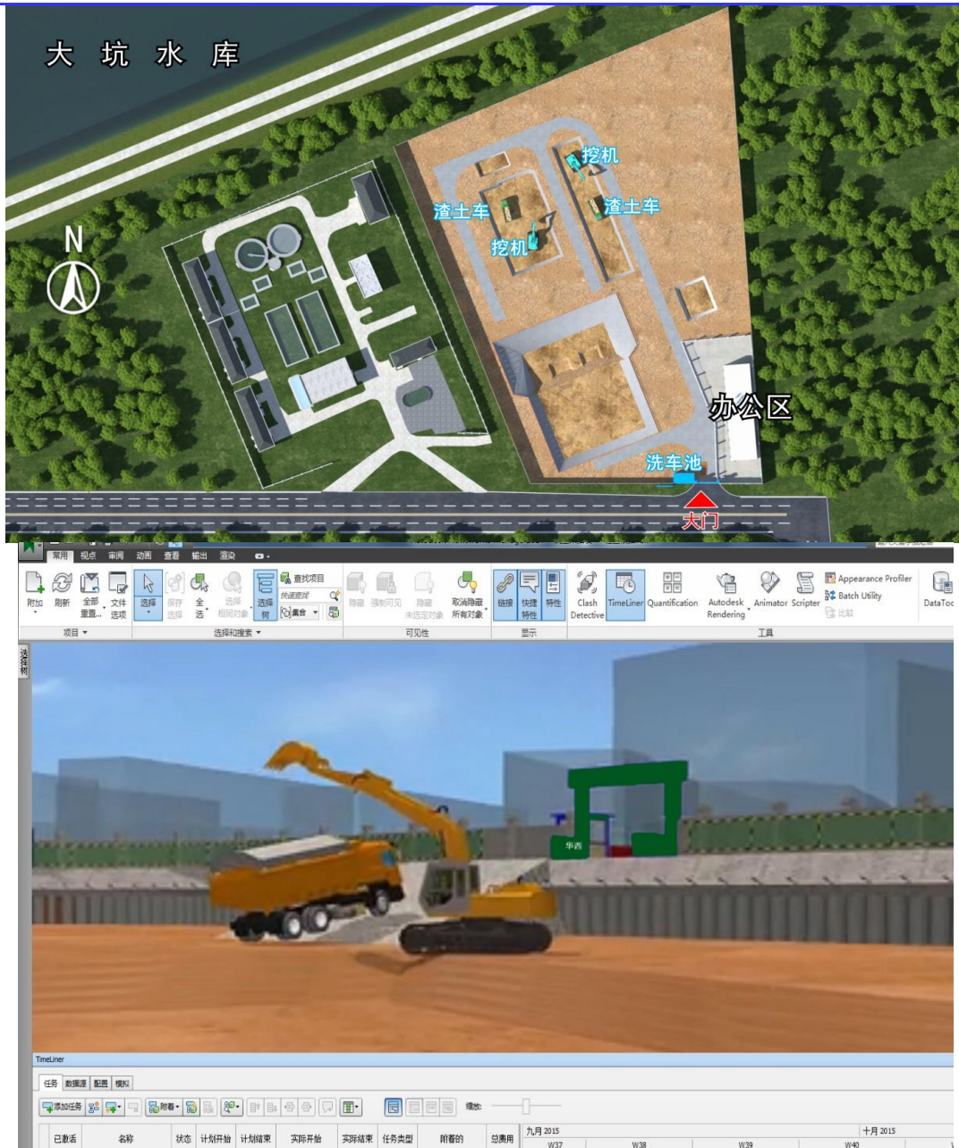
土方开挖模拟
