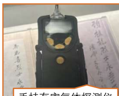
手持有害气体检测仪 2台
