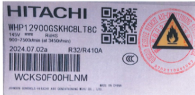
新增压缩机外观和铭牌
