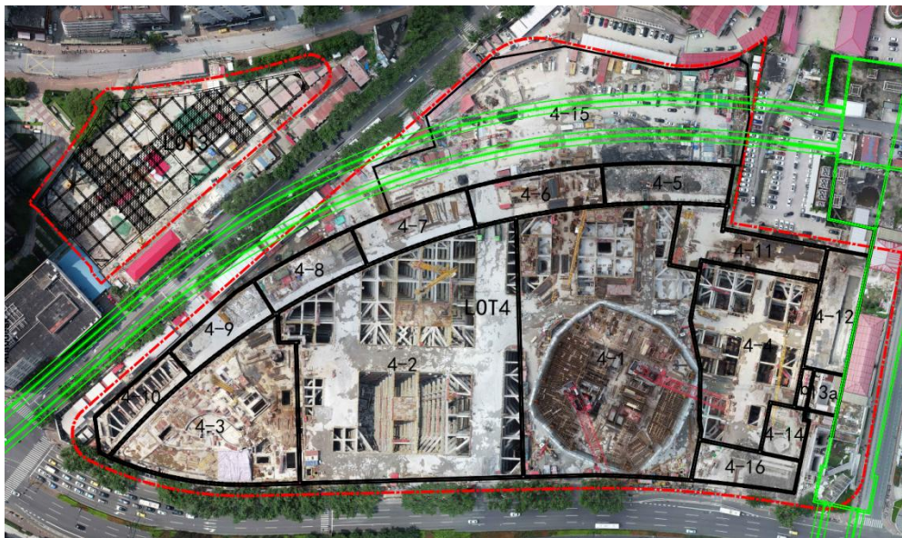
基坑施工与地铁线路位置关系
