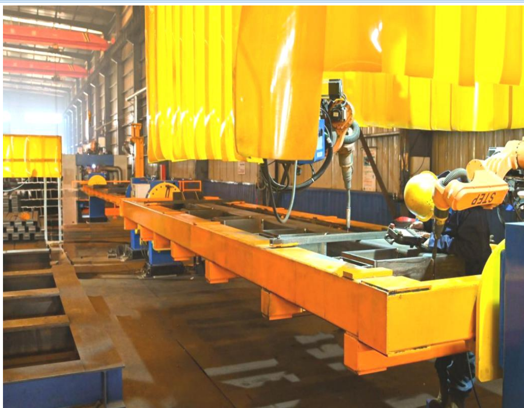
结构焊机机器人
