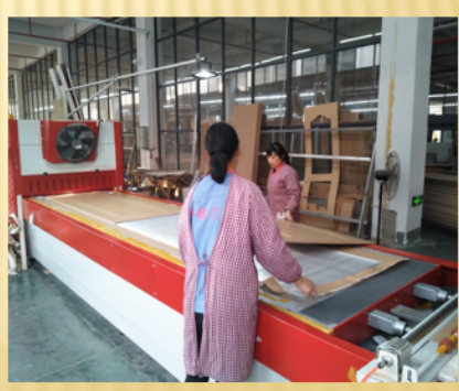
(8) 免漆柔性车间覆膜
