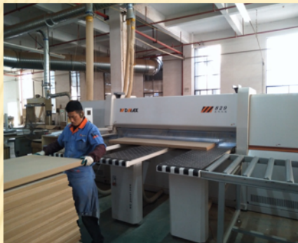
(5) 免漆柔性车间开料
