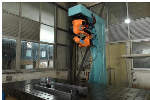
图片 13-关键设备：数控机械电焊机器人
