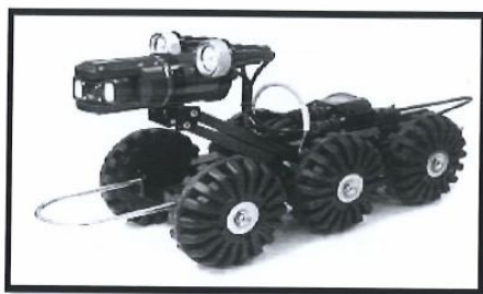
图 2-3 T 管道闭路电视内窥仪
